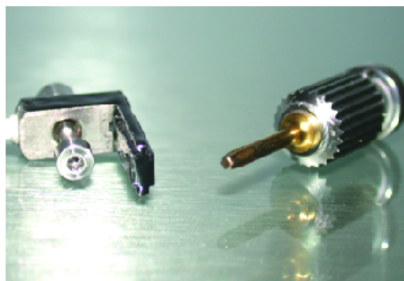
Figura 2 - Transdutor com a respectiva chave para aperto ao implante ou pilar
